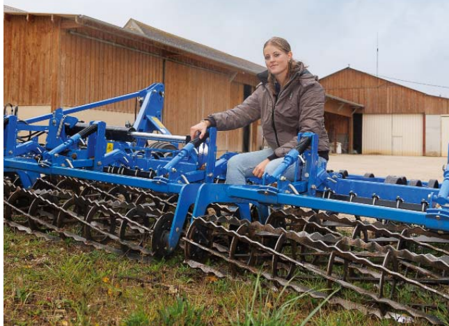
Agathe Moriano, céréalière bio, préfère cet outil, le vibroculteur, qui peigne en surface, à la charrue qui laboure et retourne en profondeur.
